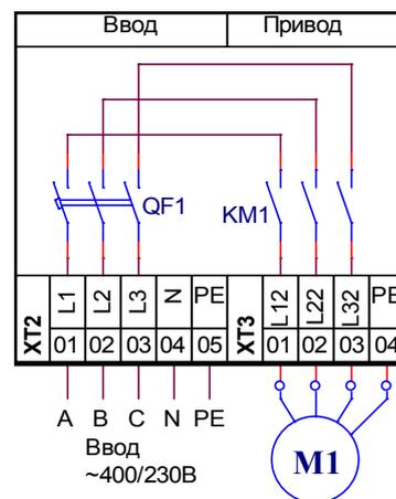
**Подключение приводов клапанов**
