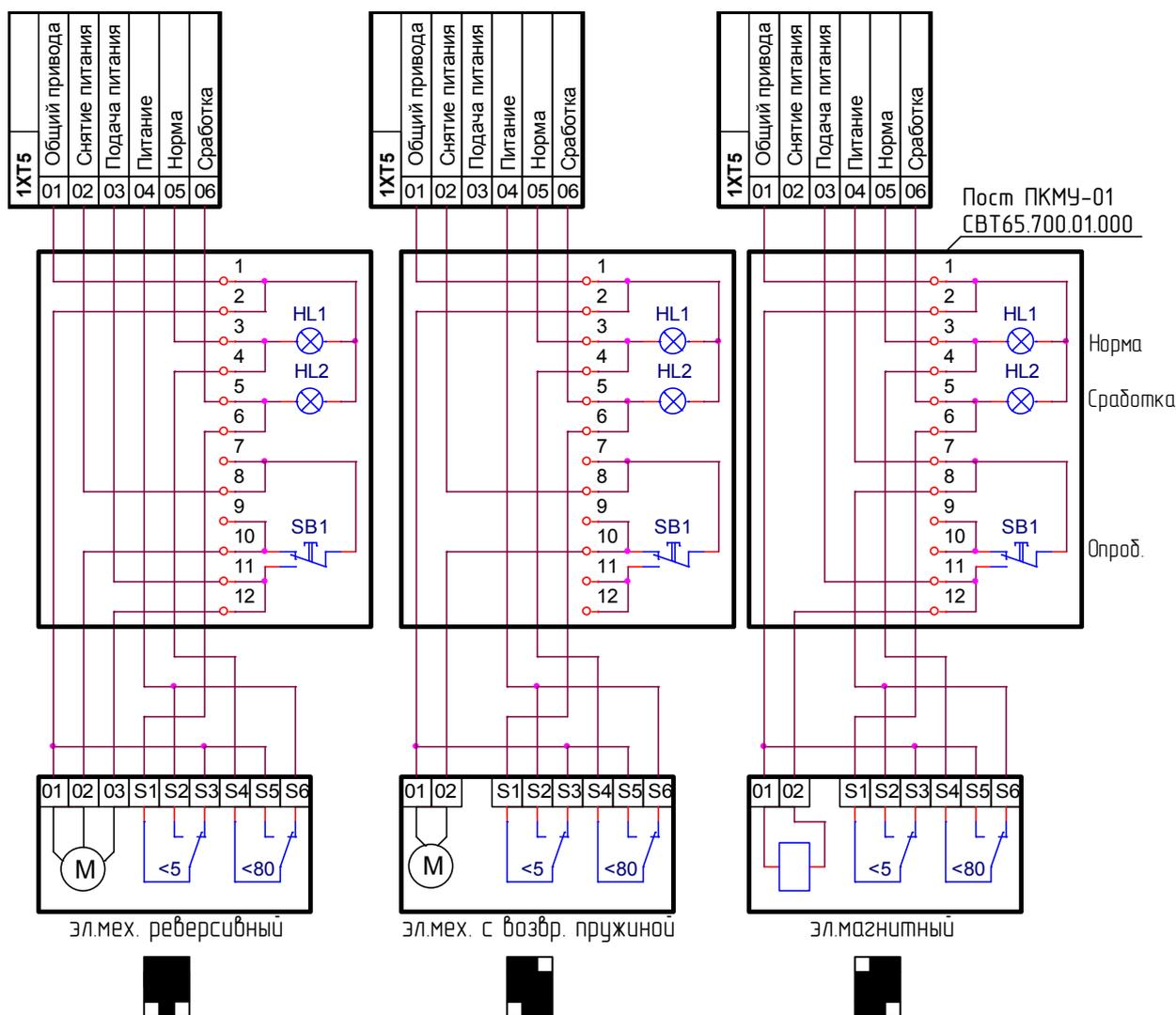
Индикаторы [Норма] и [Сработка] кнопочного поста включаются одновременно с соответствующими индикаторами шкафа управления и отражают текущее положение данного клапана.
