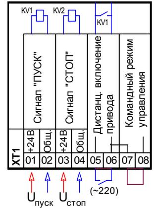
Остановить шкаф можно кратковременной подачей управляющей команды "СТОП" на клеммы ХТ1:3 - ХТ1:4 или вручную, переводом переключателя "Режим" в положение "0".
