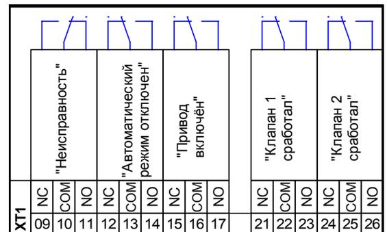
При использовании шкафа в системах противопожарной защиты на клеммы выходных сигналов шкафа при монтаже как правило устанавливаются дополнительные элементы (обычно резисторы). Тип, номиналы и схема подключения дополнительных элементов выбираются в соответствии с рекомендацией изготовителя приборов используемой системы пожарной сигнализации (пожаротушения).
